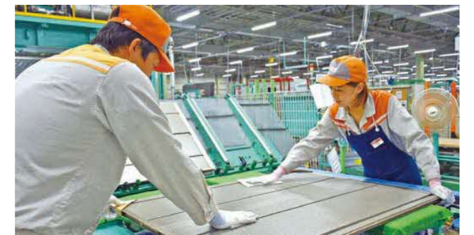
雨戸組立工程
